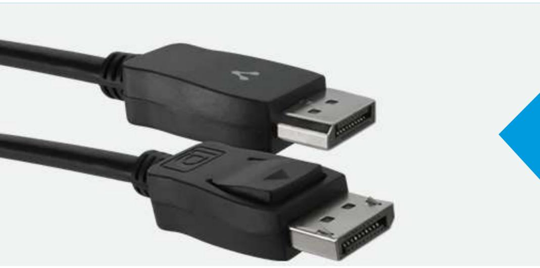
**Alta velocidad.** El CAB-309 es un cable DisplayPort 1.4 con ancho de banda de 32Gbps lo que le permiten transferir imágenes en altas resoluciones y a altas tasas de refresco sin compresión.
